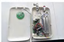
Корпус нагревателя открывается легко, крышка крепится на двух пластмассовых защёлках.
